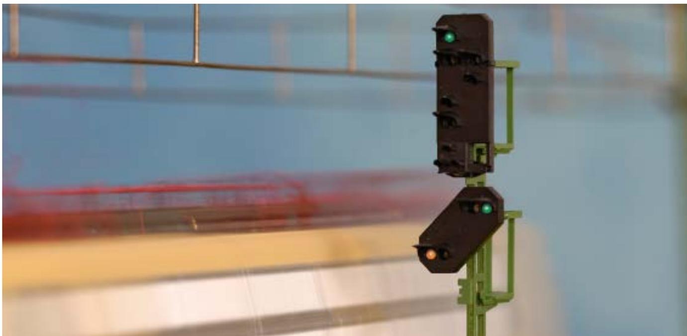
Analogamente al caricamento degli scambi andiamo avanti adesso anche con i segnali. Prima di tutto dovreste chiarire di quali decoder dispongano i vostri segnali. Sugli impianti più vecchi di regola i segnali vengono gestiti tramite i decoder universali k83 e m83.
