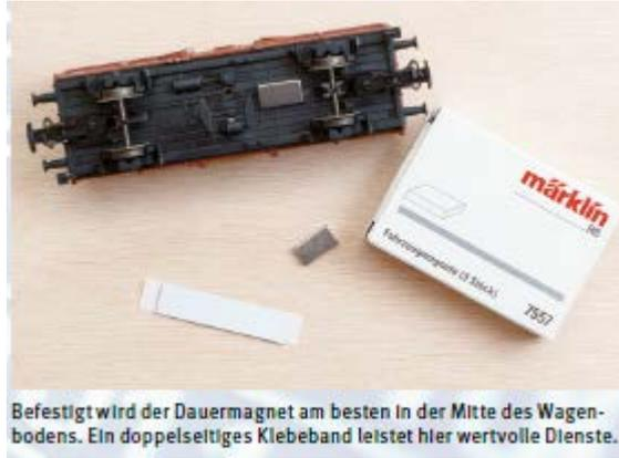
Befestigt wird der Dauermagnet am besten in der Mitte des Wagenbodens. Ein doppelseitiges Klebeband leistet hier wertvolle Dienste.
