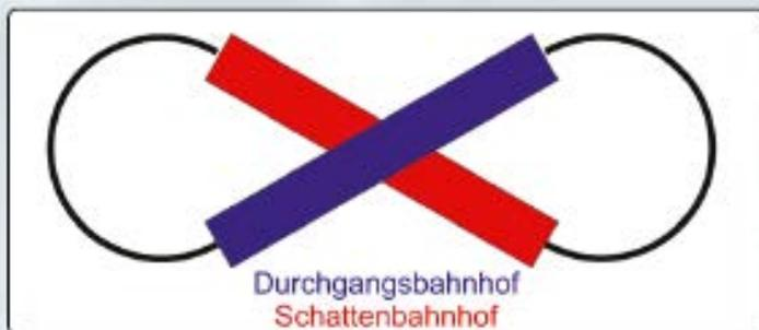
Schematischer Gleisverlauf einer Beispielanlage mit Schattenbahnhof: Durchgangsbahnhof auf der oberen Ebene, Schattenbahnhof darunter.
