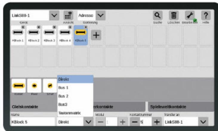
**Verbindung muss stimmen: Bei den s88-Kontakten den richtigen Anschluss wählen unter Gerät, Bus, Modul und Kontaktnummer.**
