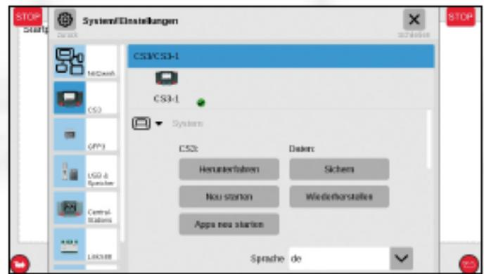
Stecken Sie zuerst den USB-Stick in eine der beiden USB-Datenbuchsen der CS3 (analog zum Update, siehe Bild unten). Die Übernahme der Daten erfolgt durch Antippen des Menüpunktes „Wiederherstellen“.
