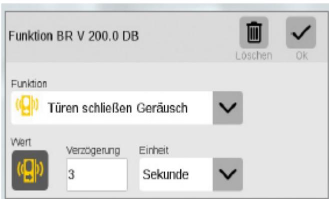
Die Parameter einer Funktion können individuell angepasst werden wie hier die Dauer für das Geräusch „Türen schließen“ (In Sekunden).
