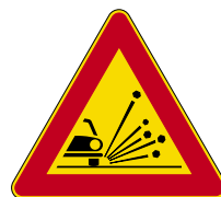
FCR 160 390 FCR 190 390 materiale instabile sulla strada
