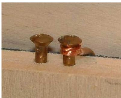
Figura 6 - Particolare delle viti di collegamento, successivamente da saldare alle rotaie
