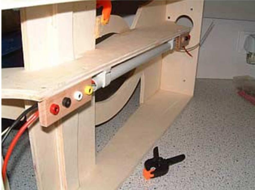
Figura 8 - Particolare delle prese di alimentazione e del loro collegamento al di sotto del modulo
