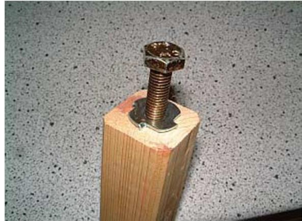
Figura 10 - Particolare del piede della gamba assemblato
