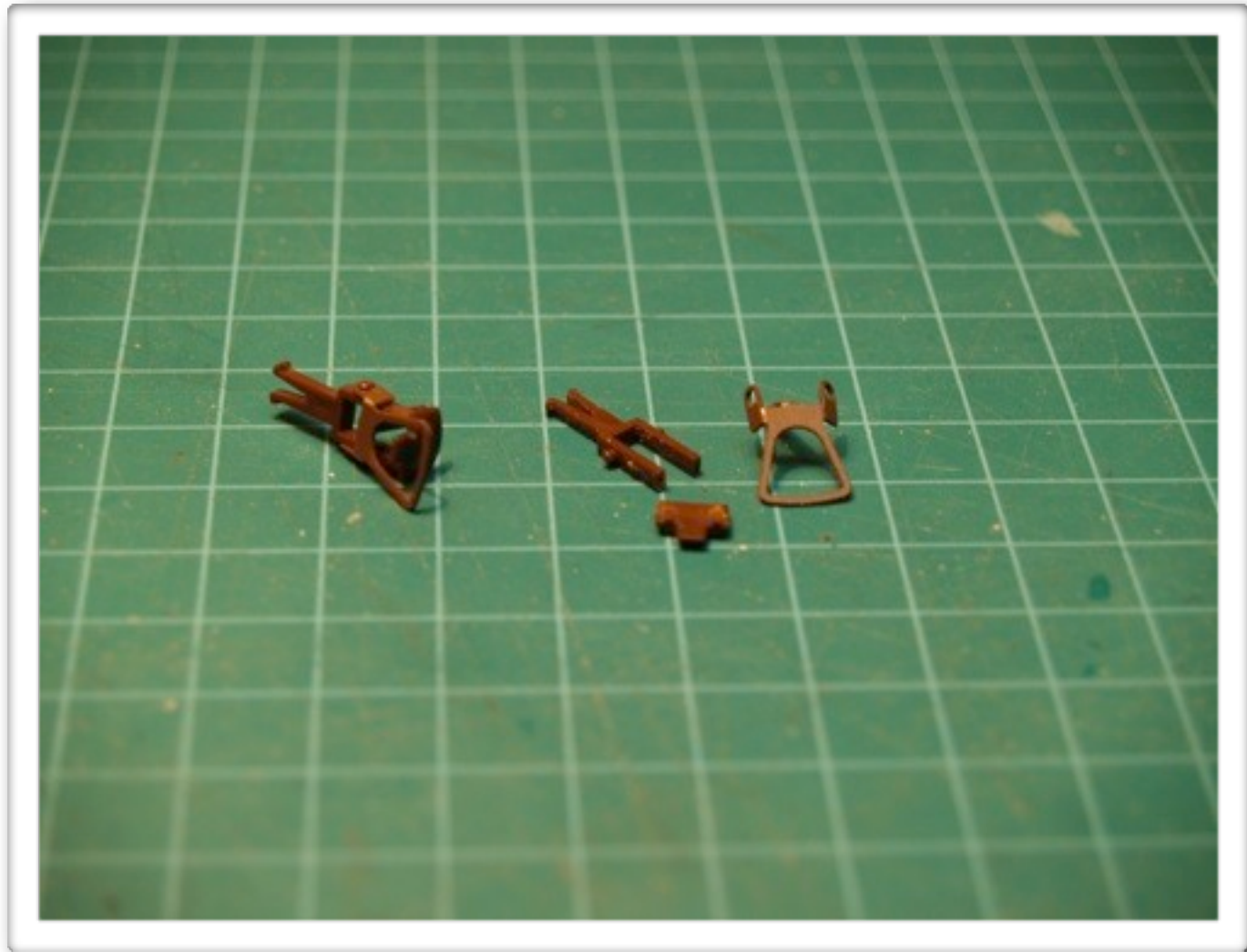
1. Gancio normale di partenza: togliere la parte mobile e tagliare il dentello
