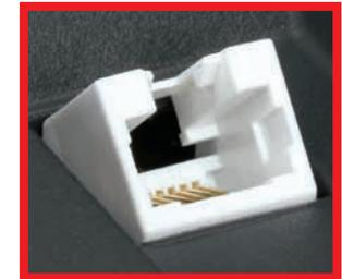
La CS3 plus dispone inoltre sul lato inferiore di una connessione S88 diretta.
