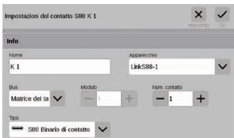
Voi potete utilizzare il Link S88 per una matrice di tasti, ad esempio per un quadro di comando sinottico dei binari. Sino a 64 tasti (32 apparati elettromagnetici oppure 64 itinerari di marcia) vengono supportati. I rispettivi punti di commutazione potete inserirli nel campo „Num. contatto“.
