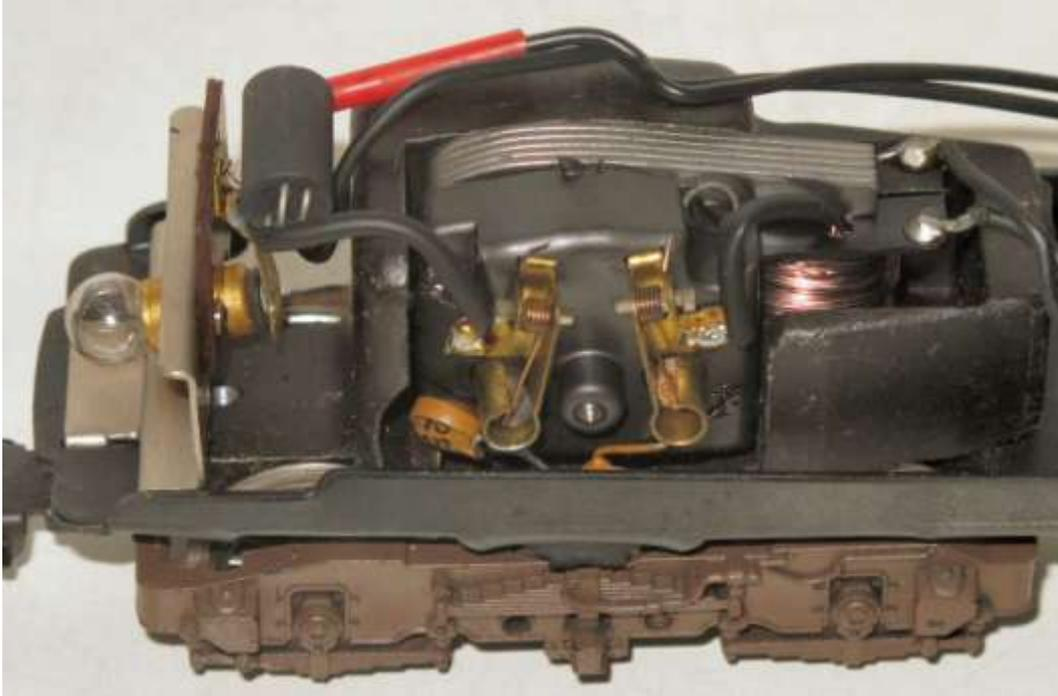
Motore prima versione dal 1964, e seconda versione con alloggiamento spugna lubrificante 20490:
