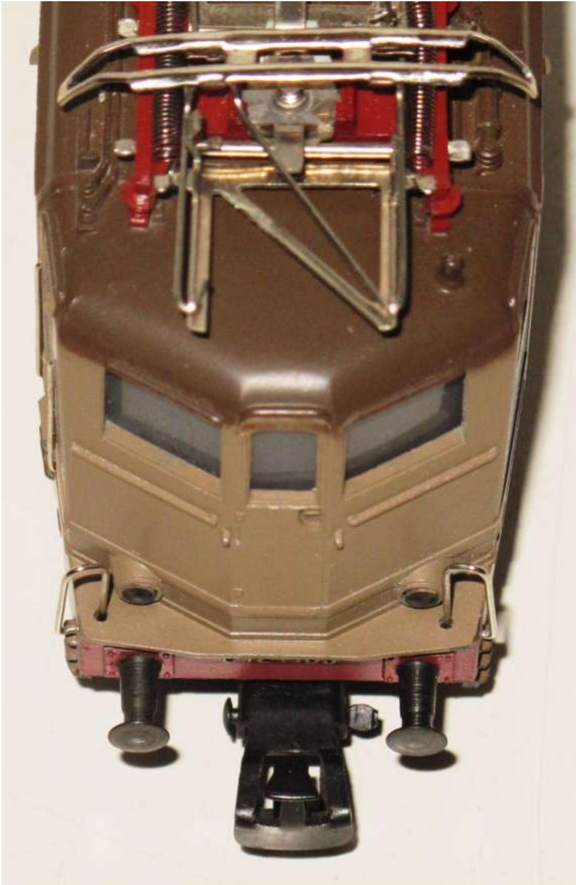
Pantografo con perni passanti prima e seconda versione 21500 (7218):
